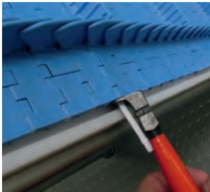
4 剪掉输送带边缘后侧的凸出杆端
